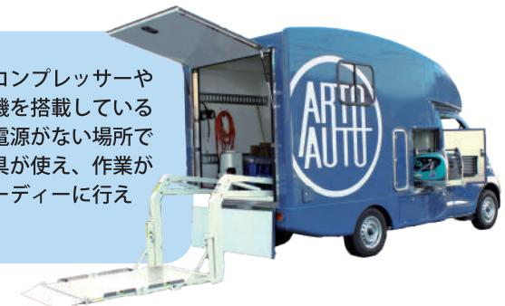
エアコンプレッサーや発電機を搭載しているので電源がない場所でも工具が使え、作業がスピーディーに行えます。
